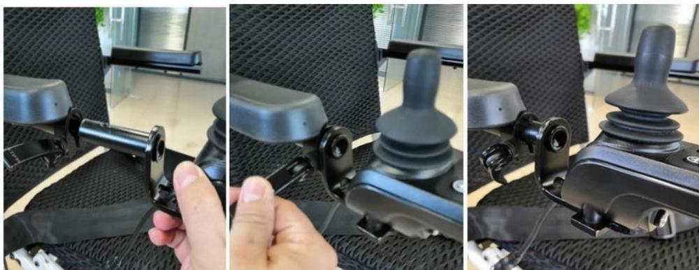
**Installazione della ruota antiribaltamento:** Installare la ruota antiribaltamento e fissarla con il bullone.
