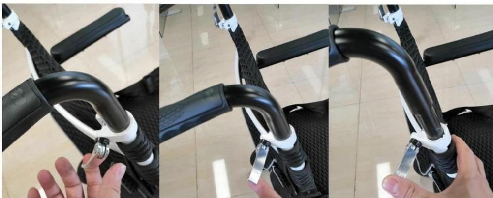
**Operazione di regolazione del telecomando:** rilasciare la maniglia della leva di sgancio rapido per regolare o rimuovere il telecomando.
