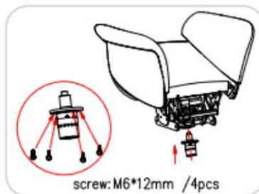
2. Fissare l'albero del perno sulla traversa nella parte inferiore del telaio con le viti (M6\*12 mm/4 pezzi).
