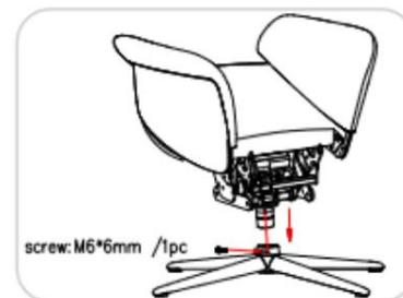
3. Inserire l'albero girevole verticalmente nel foro centrale della base delle gambe, il foro all'esterno della base delle gambe allineato con il foro sul lato dell'albero girevole con le viti (1/ M6\*6MM).
