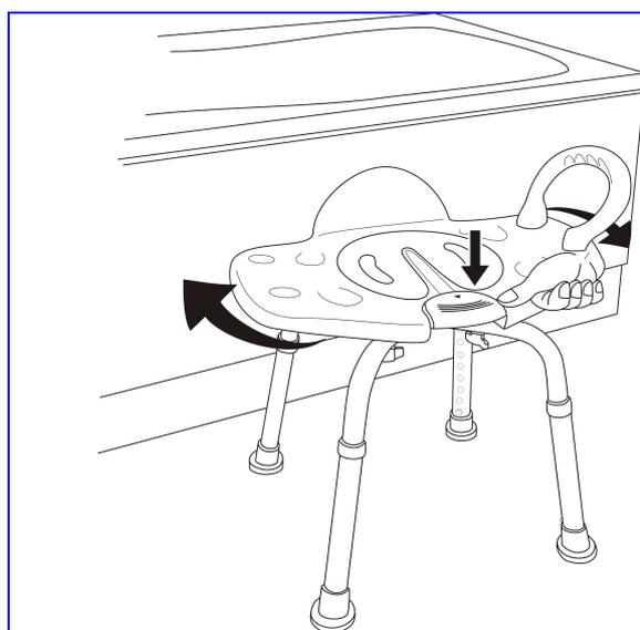
1. Regolare l'altezza del sedile, sedersi. Spingere l'apposita linguetta verso il basso per ruotare il sedile.
