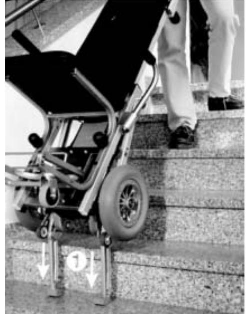
9. Una volta che le staffe di appoggio ❷ toccano terra si caricano del peso che grava sulle ruote e le ruote stesse con tutto il telaio ❸ vengono sollevate.
