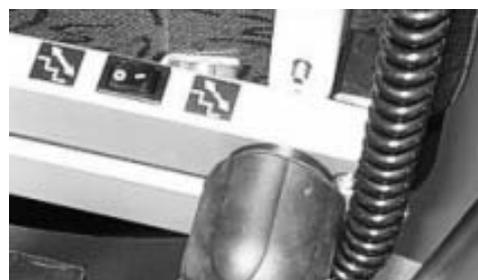
La linea tratteggiata sullo schema a destra simboleggia l'interruzione del movimento, cioè l'inserimento della modalità "singolo scalino" per tale funzione premere l'interruttore sulla posizione "I". Premendo l'interruttore sulla posizione "O" l'apparecchio si muove in modo continuo, quindi la modalità singolo scalino è disinserita.
