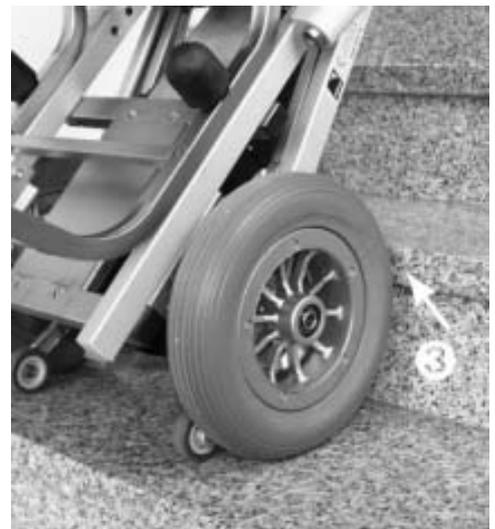
7. Il movimento di salita avviene in due tempi per ogni scalino.
