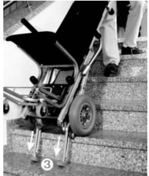
10. Una volta che le staffe di appoggio hanno raggiunto lo scalino successivo ④, queste si caricano del peso che grava sulle ruote e queste, insieme al telaio, vengono leggermente sollevate ⑤ e proseguono il loro ciclo in avanti.
