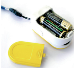
Figura 3 Installazione delle batterie
