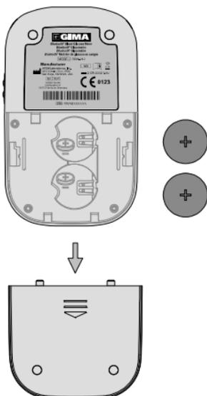
2. Inserire due batterie a bottone CR 2032 da 3,0 V nuove sul nastro adesivo. Assicurare che il polo positivo (+) sia rivolto verso il lato superiore dell'alloggiamento.
