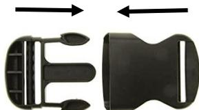
Per aprire il sistema di chiusura con clips in plastica premere verso l'interno su ciascun lato per rilasciare la chiusura. Per agganciare, inserire le due parti insieme e applicando una leggera pressione.
