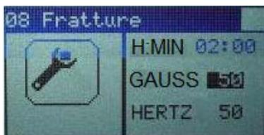
4. Tramite i tasti ▲ e ▼ impostare l'intensità del trattamento (da 5 a 100 Gauss nei programmi P1-P20, da 5 a 150 Gauss nei programmi P21-P35) e confermare premendo il tasto OK.
