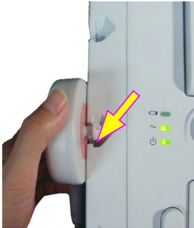
Posizionamento del trasduttore
