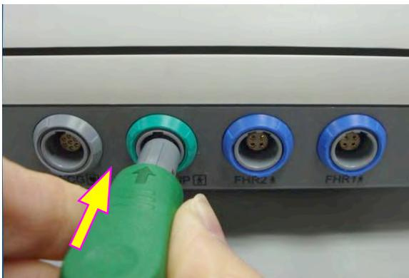
Collegamento del trasduttore
