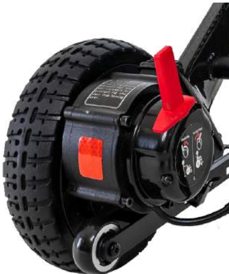
Leva sblocco motore per una spinta
