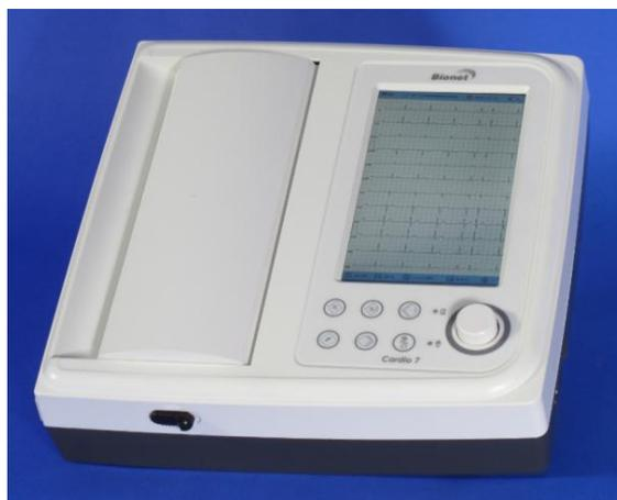
Cardio7 è un elettrocardiografo (ECG) in grado di misurare e registrare 12 canali di segnali cardiaci del paziente. L'apparecchiatura permette all'operatore di registrare i segnali cardiaci, di rivederli utilizzando diverse modalità di visualizzazione e di eseguire il rilevamento automatico delle condizioni cardiache.
