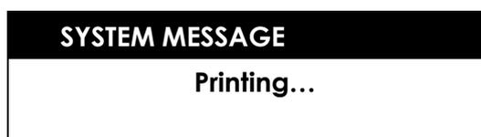
Premere il tasto PAUSE (Ⓜ) per interrompere il salvataggio dei dati o il processo di stampa e uscire. Dopo aver premuto il tasto, il seguente messaggio verrà visualizzato sullo schermo LCD per 1 secondo e il sistema arresterà il processo di salvataggio o di stampa.
