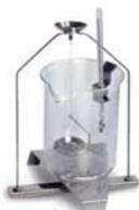
**Set per la determinazione** della densità di liquidi e solidi con densità  $\geq 1$ , KERN ALS-A01
